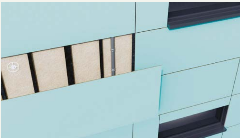
Geventileerde gevelconstructies kunnen afzonderlijk worden gedemonteerd, waardoor ze kunnen worden hergebruikt en/of gerecycled
